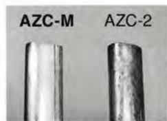
製品表面の湯ジワ・フクレ減少→メッキ不良の減少
